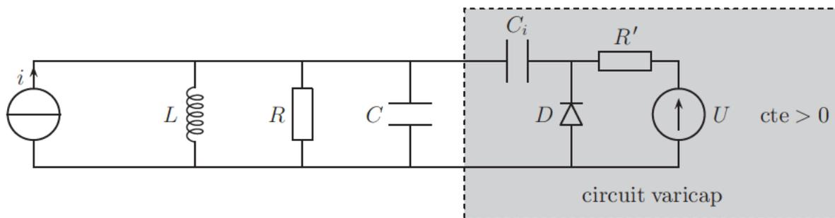
FIGURE 6 – Oscillateur électrique de récepteur radio.
