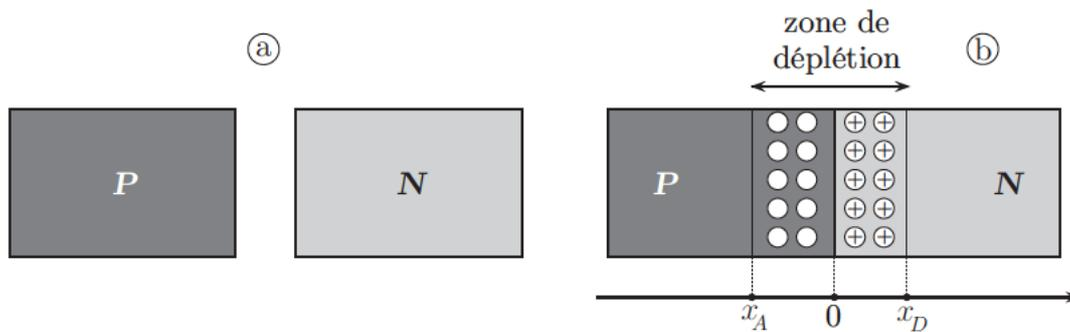
FIGURE 3 – Réalisation d'une jonction PN en  $x = 0$ .
