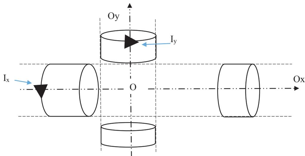
**Fig. 1** – Configuration des solénoïdes. Les solénoïdes sont infiniment longs, seules quelques spires ont été représentées.
