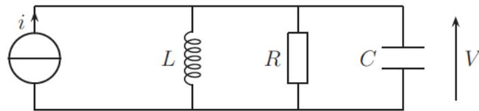
FIGURE 5 – Circuit électrique alimenté par un générateur d'intensité.
